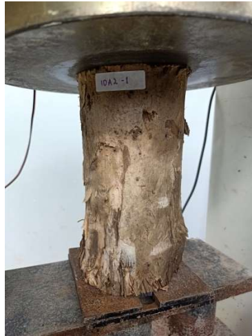
Gambar 2. Pengujian Kuat Tekan Kayu Galam
