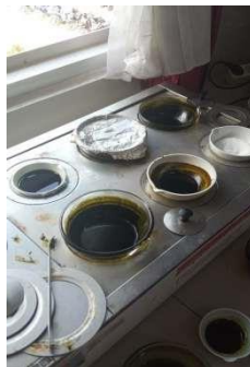
Proses Waterbath untuk menguapkan sample
